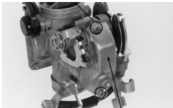
TAMPA SUPERIOR DO CARBURADOR
