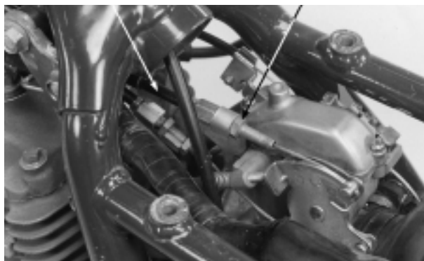
CABO DO ACELERADOR
