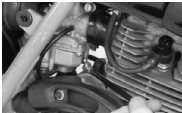
PARAFUSO DE ACELERAÇÃO
